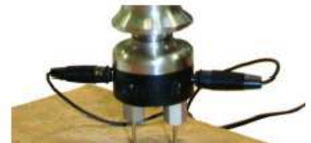
Fig. 9: Forbindelse af kabel til træ fugtprobe
