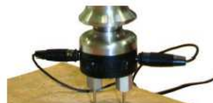
Fig. 9: Anslutning av kabel till träfuktprob
